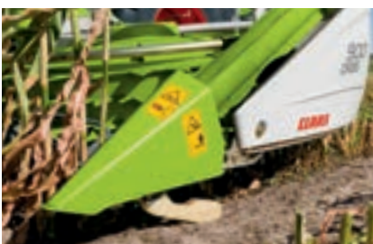
AUTO CONTOUR, Auflagedruckregelung mit Querausgleich
