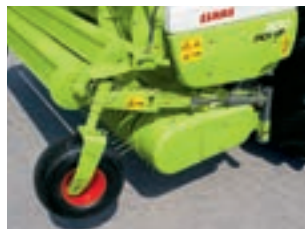
Hydraulisch klappbare Tasträder
