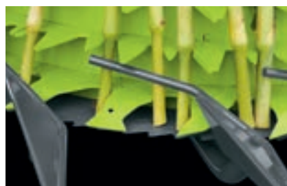
Schonender Pflanzentransport und Messerselbstschärfefeekt
